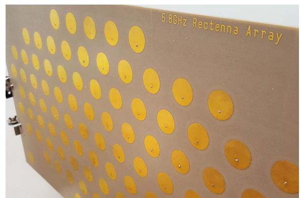
L'antenne Rectenna, utilisée au sol pour récupérer l'énergie envoyée de l'espace
